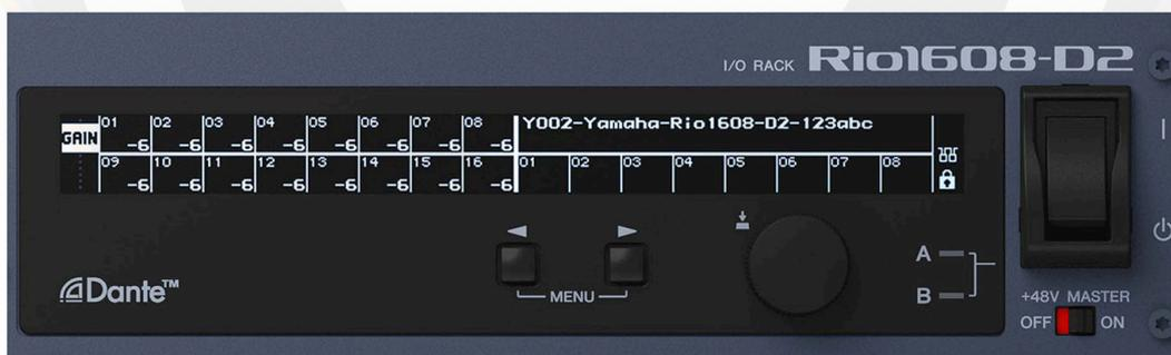
Ai Led, montati sulla precedente serie R, si è preferito utilizzare un display che tramite una navigazione multi pagina permette di tenere sotto controllo le impostazioni Dante, della Gain Compensation, oltre che i valori Gain, HPF, Phantom Power sui quali si può intervenire tramite tasti e controllo rotativo. I moduli RIO-D2 sono ovviamente compatibili con la precedente serie R ed anch'essi sono controllabili tramite software di gestione R Remote.
